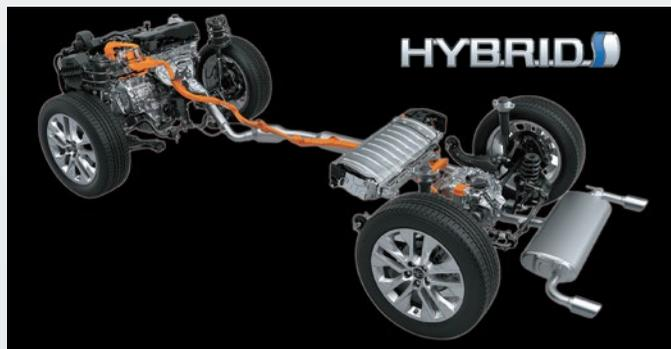
El sistema híbrido auto-recargable de Toyota RAV4 está compuesto por **dos motores** (naftero + eléctrico) que trabajan conjuntamente, otorgando una potencia total de **222 CV**.
