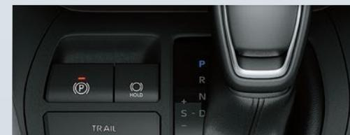
FRENO DE ESTACIONAMIENTO ELÉCTRICO CON FUNCIÓN "AUTO-HOLD".
