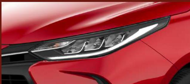
Ópticas delanteras LED con regulación en altura.<sup>(2)</sup>
