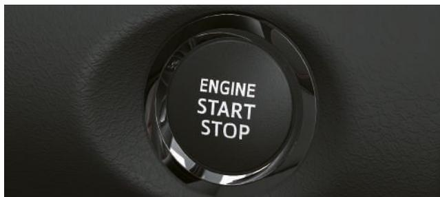
Sistema de encendido por botón (Push Start Button) y Sistema de ingreso inteligente (Smart Entry System).<sup>(2)</sup>
