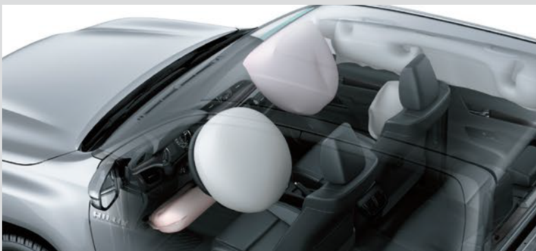
7 airbags: frontales (x2), de rodilla (conductor), laterales (x2) y de cortina (x2) *3
